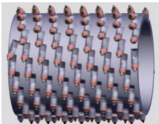
Tambour de fraisage microfin Largeur de fraisage: 450 + 2 x 25 mm Profondeur de fraisage: 0 – 30 mm Écartement de pics: 3 mm
